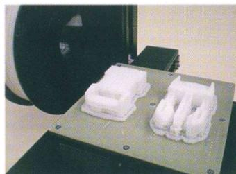
UP!3D Printerで印刷
